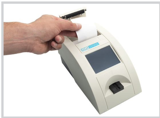
Abbildung 5: Einlegen des Druckerpapiers in den DOASENSE Reader
