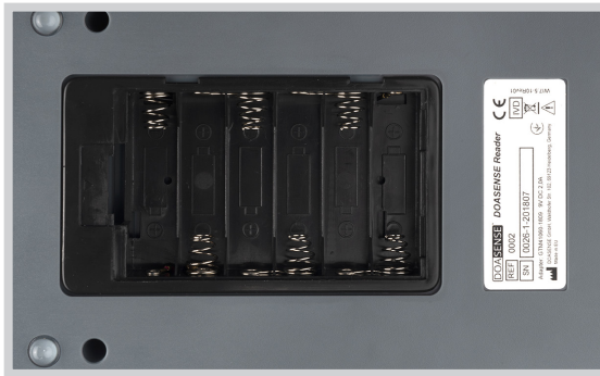
Abbildung 11: Batteriefach an der Unterseite des DOASENSE Reader
