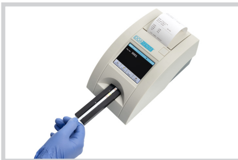
Abbildung 6: Auflegen des Teststreifens auf den Streifenhalter des DOASENSE Reader
