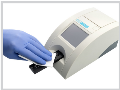
Abbildung 7: Reinigen des Streifenhalters
