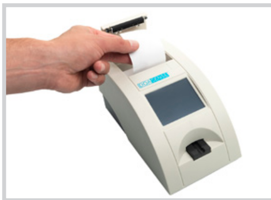
Figure 5 : Insertion de papier thermique dans le DOASENSE Reader
