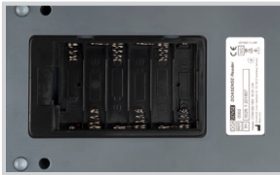
Figure 11 : Le compartiment à piles dans la partie inférieure du DOASENSE Reader
