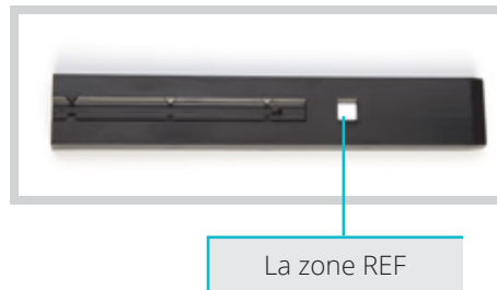
Figure 8 : Nettoyage de la zone REF dans la partie inférieure du tiroir porte-bandelette
