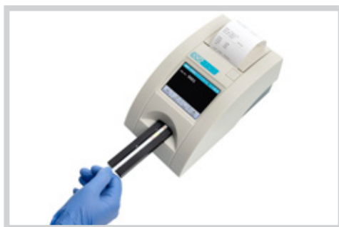
Figure 6 : Placement de la bandelette réactive sur le tiroir porte-bandelette du DOASENSE Reader
