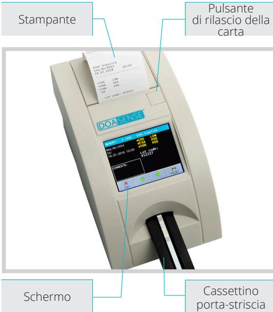
Figura 2: Descrizione della parte anteriore dello strumento
