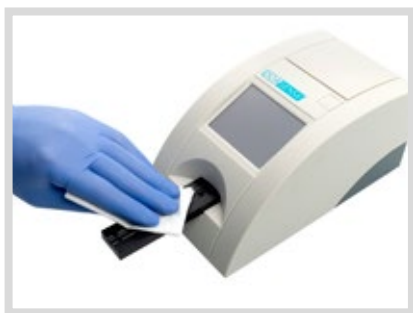
Figura 7: Limpeza do suporte para tiras
