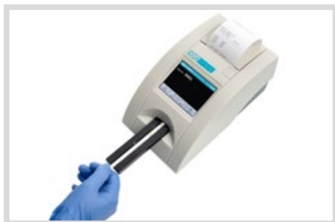
Figura 6: Colocação da tira reagente no suporte do DOASENSE Reader
