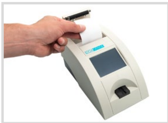
Figura 5: Instalação do papel térmico no DOASENSE Reader
