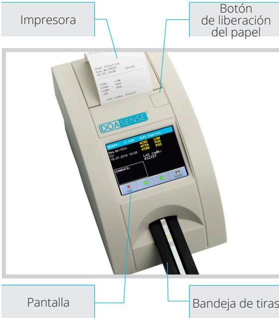
Figura 2: Descripción de la parte delantera del instrumento
